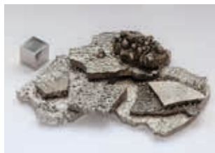
Fig. 116. Cobalto puro obtido por refino electrolítico.
