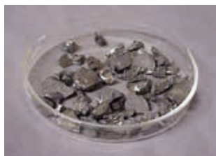
Fig. 17. Boro β-romboédrico (forma alotrópica máis estable termodinamicamente).
