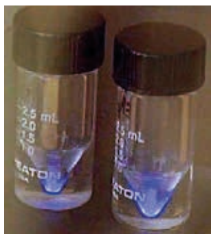
Fig. 340. Dúas mostras de ^{225}\text{Ac} en viais. Na escuridade emite unha luz azul debido a que a súa intensa radioactividade excita o ar ao seu redor.
