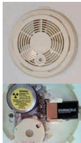
Fig. 363. Parte exterior (arriba) e interior (abaixo) dun detector de fume que incorpora americio.
