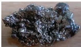
Fig. 225. Anaco de bario nunha atmosfera protectora de argon.
