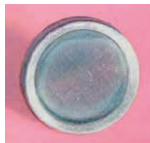
Fig. 324. Película delgada de polonio nun disco de aceiro inoxidable, forma en que se vende como fonte de partículas \alpha para uso científico.
