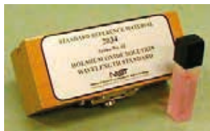
Fig. 264. Cubeta de cuarzo que contén unha disolución de óxido de holmio (4%) en ácido perclórico (10%), utilizada como estándar de calibración óptica.
