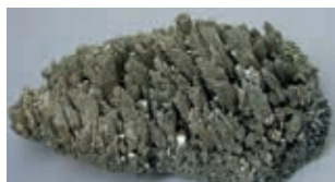
Fig. 46. Cristais de magnésio depositados polo proceso Pidgeon.
