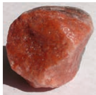
Fig. 48. Carnalita ( \text{KMgCl}_3 \cdot 6\text{H}_2\text{O} ).
