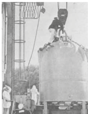
Fig. 372. Contedor de cincuenta toneladas construído no Oak Ridge National Laboratory para transportar un gramo de ^{252}\text{Cf} .
