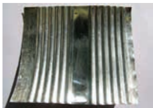
Fig. 206. A lata é unha folla de ferro recuberta dunha capa de estaño para que non se enferruxe.
