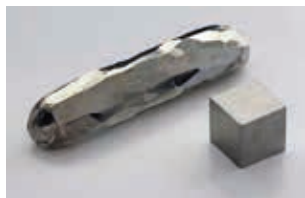
Fig. 195. Barra de cristal de cadmio xunto cun cubo do metal de 1 cm 3 .
