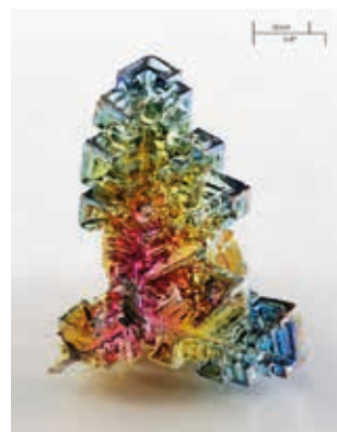
Fig. 322. Cristais de bismuto que amosan as múltiples refraccións iridiscents provocadas polo óxido formado na súa superficie.
