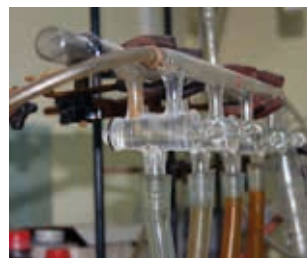
Fig. 80. Liña de baleiro utilizada no laboratorio para traballar con substancias reactivas ao ar; o interior dos tubos das liñas adóitase encher cun gas inerte como o argon.
