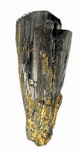
Fig. 172. Peza de coltan, mineral utilizado para desenvolver condensadores en equipos electrónicos de alta eficiencia volumétrica.
