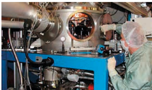
Fig. 404. Imaxe da cámara de destino para os experimentos de feixe láser e de ións no acelerador UNILAC do GSI de Darmstadt.
