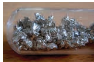
Fig. 85. Calcio metal purificado e gardado en atmosfera inerte de argon.
