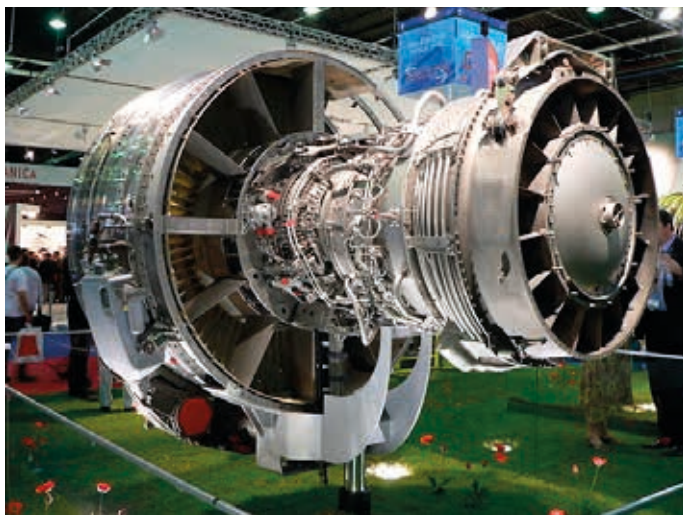
Fig. 289. Imaxe dun motor a reacción CFM International CFM56 con aspas que conteñen un 3% de renio.
