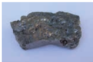
Fig. 114. Aliaxe de ferrosilicio. As fábricas da empresa FerroAtlántica en Cee e Dumbria producen anualmente ao redor de 79 000 toneladas deste material.
