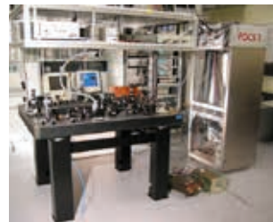
Fig. 224. Imaxe do FOCS1, reloxo atómico de cesio, en Suíza, que comezou a operar en 2004 cunha desviación de 1 s en 30 millóns de anos.
