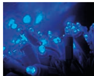
Fig. 134. Díodos emisores de luz (LED) azuis baseados en Ga.
