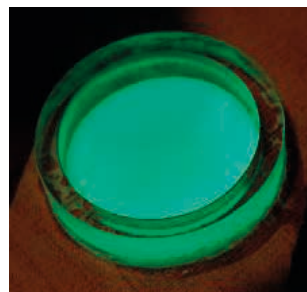
Fig. 246. Cloruro de prometio(III) utilizado como fonte de luz tras a aplicación de calor.
