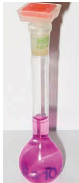
Fig. 108. Disolución acuosa de permanganato potásico, un oxidante onde o manganeso está en estado de oxidación +VII.
