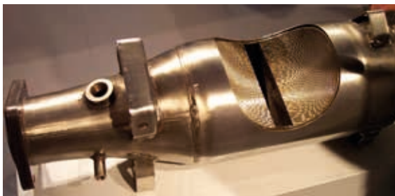
Fig. 235. Convertedor catalítico dun automóbil cun corte aberto para amosar a superficie metálica do catalizador.
