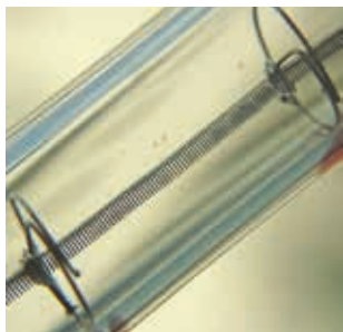
Fig. 286. Detalle dun filamento de volframio nunha lámpada halóxena.
