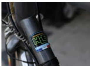
Fig. 109. Etiqueta no cadro dunha bicicleta que indica a presenza de mangallo, unha aliaxe de aceiro ao manganeso caracterizada pola súa alta resistencia ao impacto e á abrasión.
