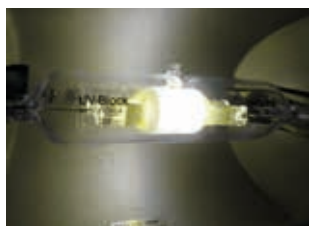
Fig. 92. Lámpada comercial de haluros metálicos que contén \text{ScI}_3 .
