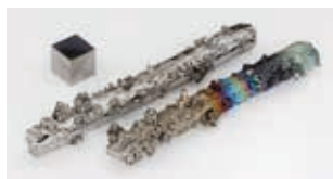
Fig. 283. Barras de volframio con cristais do metal na superficie. A oxidación parcial provoca unha coloración característica.
