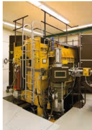
Fig. 369. Imaxe dun ciclotrón moderno utilizado en radioterapia.
