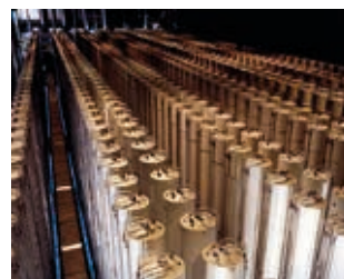
Fig. 352. Centrifugadoras utilizadas polo Departamento de Enerxía dos EUA para enriquecer uranio nos seus isótopos fisiónables.
