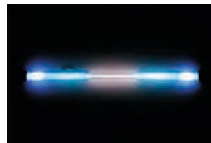
Fig. 151. Tubo de descarga cheo de cripton puro.
