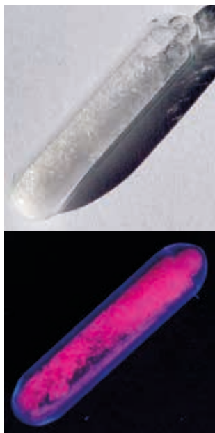
Fig. 252. Na parte superior, tubo con sulfato de europio, \text{Eu}_2(\text{SO}_4)_3 , e na parte inferior, o mesmo tubo coa fluorescencia vermella deste sulfato baixo a incidencia de luz ultravioleta.
