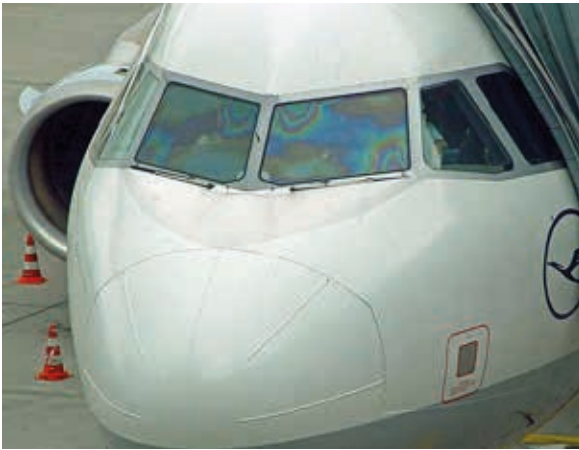
Fig. 202. Parabrisas dun Airbus en que se utiliza unha capa transparente e condutora de ITO para protexelo das xeadas.
