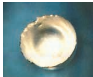
Fig. 378. Fotografía dunha aliaxe fermio-iterbio, utilizada para medir a entalpía de vaporización do fermio metal.
