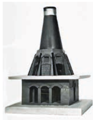
Fig. 129. Modelo de forno para destilar cinc utilizado por William Champion, recreado polo Bristol Industrial Museum.
