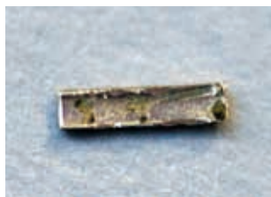
Fig. 337. Radio electrochapado sobre unha pequena lámina de cobre e recuberto con poliuretano para evitar a súa oxidación ao ar.
