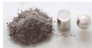
Fig. 184. Rodio en po e compactado en forma cilíndrica.
