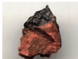
Fig. 256. Gadolinita, un silicato de fórmula (\text{Ce,La,Nd,Y})_2\text{FeBe}_2\text{Si}_2\text{O}_{10} .
