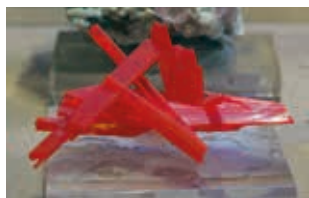
Fig. 103. Cristais de crocoíta ( \text{PbCrO}_4 ).
