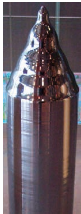
Fig. 59. Peza de silicio monocristalino obtida polo crecemento a través do proceso Czochralski.
