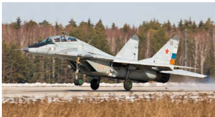
Fig. 91. Algunhas partes do MIG-29, como o da imaxe, están feitas dunha aliaxe Al-Sc.
