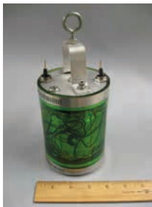
Fig. 260. Imaxe dun transdutor acústico baseado en Terfenol-D, utilizado na sondaxe de xacementos de petróleo.
